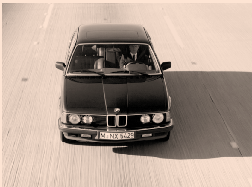
BMW 7er-Serie, mit Sikaflex verklebte Windschutzscheibe
